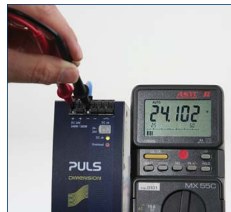
Bei geschlossener Klemme kann von vorne die Spannung abgetastet werden
