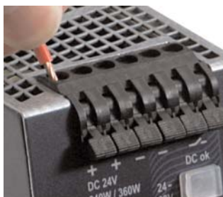
Bedienung der Klemme: Klemme öffnen, Draht einführen, Hebel schließen – fertig ist die sichere und zuverlässige Verbindung.
