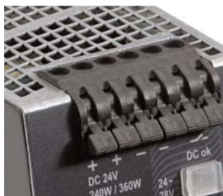
Bedienung der Klemme: Klemme öffnen, Draht einführen, Hebel schließen – fertig ist die sichere und zuverlässige Verbindung.
