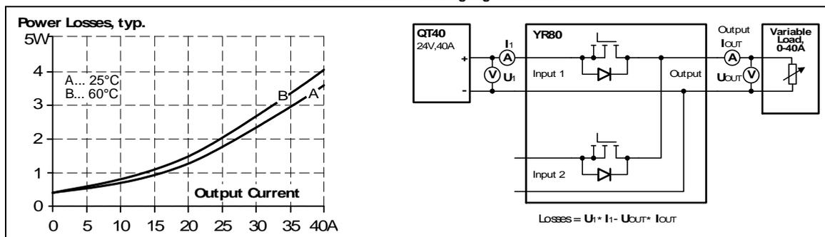
**Hinweis:** Sobald Spannung an Eingang 2 angelegt wird, werden weitere 0,35W verbraucht. Es ist nicht von Bedeutung, ob dieser Kanal zum Ausgangsstrom beiträgt oder nicht.
