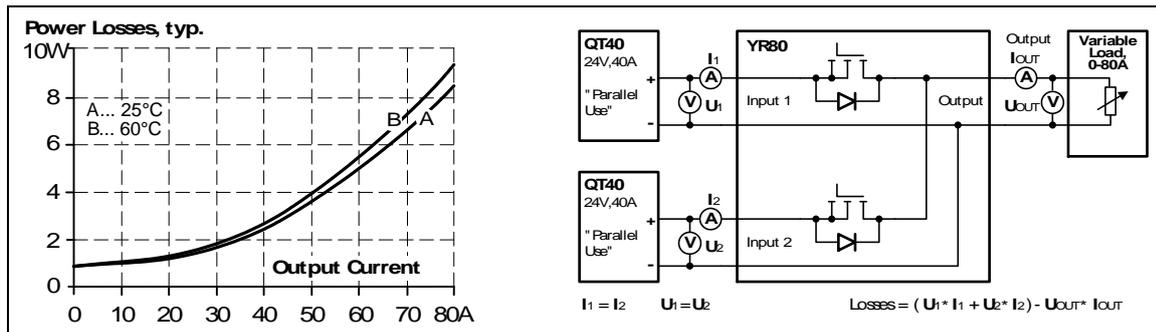
Bild 4-2 Verluste wenn nur ein Eingang verwendet wird
