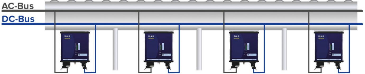
► Zur Leistungserhöhung oder Redundanz lassen sich die Geräte der Basic-Serie parallel schalten.
