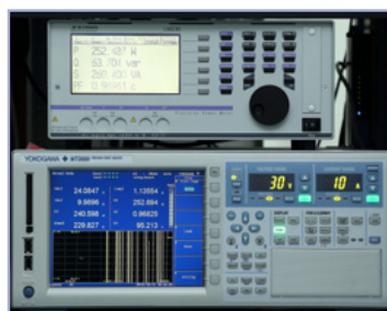
Bild 1: Der Wirkungsgrad von PULS Schaltnetzteilen wird mit hochmodernen Leistungsanalysatoren gemessen.
