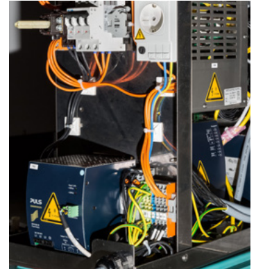
Das kundenspezifische Puffermodul in der Bildmitte, dient zur Abdeckung der Lastspitzen und wird durch die modifizierten QT40.241 nachgeladen.
