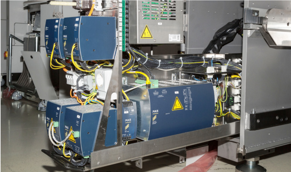
Das kundenspezifische Puffermodul in der Bildmitte, dient zur Abdeckung der Lastspitzen und wird durch die modifizierten QT40.241 nachgeladen.
