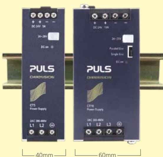
Die CT5-Serie ist verfügbar mit 12V, 8A oder einem 24V, 5A Ausgang. Die CT10-Serie ist verfügbar mit 24V, 10A oder einem 48V, 5A Ausgang.
