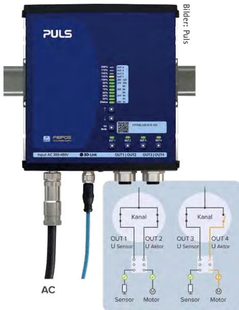
Bild 1: Jeder Ausgang verfügt über zwei voneinander getrennte Kanäle für Sensoren (U<sub>s</sub>) und Aktoren (U<sub>a</sub>).
